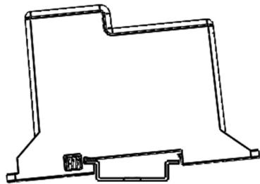
1. Accrochez le côté ligne sur un rail DIN de 35 mm
